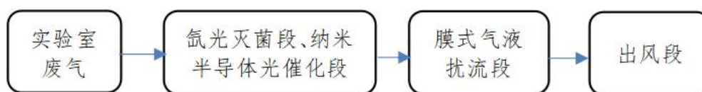
图 6.1-1 一体扰流喷淋除臭工艺流程
